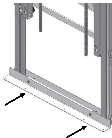
6.2.2 Monter le profilé inférieur à l'aide des deux vis.
