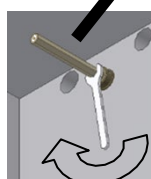
6.6.2 Tourner l'arbre en toute sécurité pour monter correctement le moteur. Serrer les deux vis. L'œillet du fil de terre jaune/vert doit être monté sur l'une des vis.
