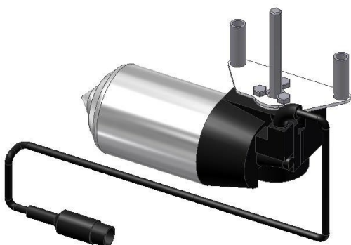
6.6.1 Le moteur, avec la broche, est monté à travers la plaque arrière et dans la boîte de vitesses.
